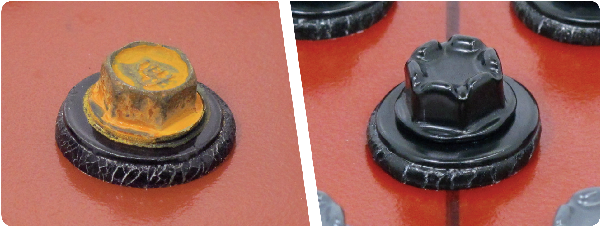
Peltikaton kateruuvien CE-merkintä ei takaa ruuvien korroosiokestävyyttä. Vasemmalla CE-merkitty kateruuvi testin jälkeen. Oikealla C3-hyväksytty KINGI® kateruuvi testin jälkeen.
